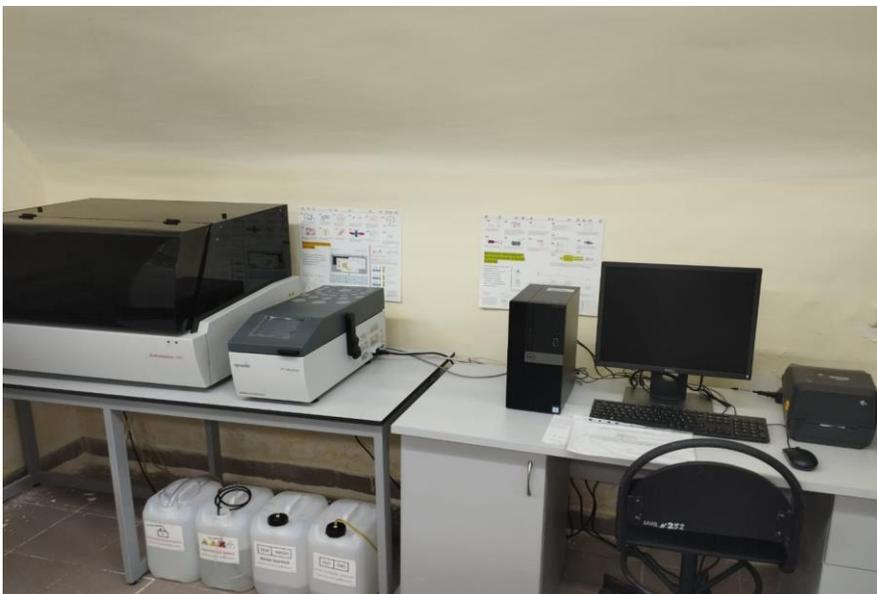
*Рис. 2.* Установка для иммуногистологического окрашивания препаратов (автостейнер) EpreDia Autostainer 360.
